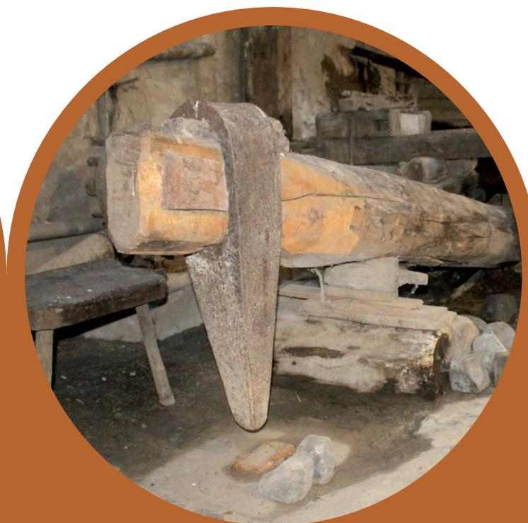
El martinete con la cabeza metálica que martillea (bate) la pieza de cobre. Fotografía SERCAM.
