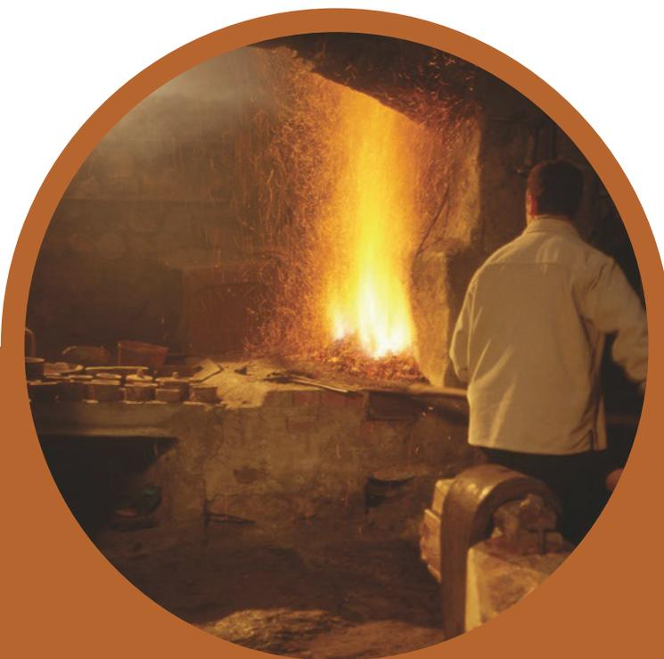
Fundición alimentada por el aire que dan las «trompas».
